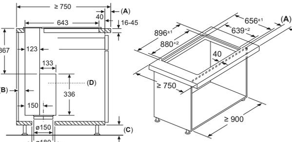
L'utilisation avec une table de cuisson à gaz n'est pas possible. Afin de s'assurer que l'appareil ne perde pas de puissance, n'installez pas d'unités murales au-dessus de l'appareil et conservez les espaces suivants :
