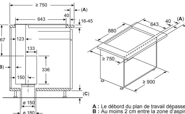
L'utilisation avec une table de cuisson à gaz n'est pas possible. Afin de s'assurer que l'appareil ne perde pas de puissance, n'installez pas d'unités murales au-dessus de l'appareil et conservez les espaces suivants :
