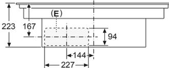
**Mode recyclage sans conduit d'installation (kit plug & play livré avec l'appareil)**
