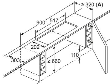
Installer la hotte télescopique avec le module cleanAir Plus et le kit de suspension
