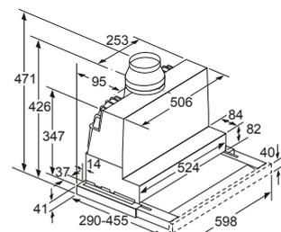
Réglage de la profondeur du tiroir-filtre possible jusqu'à 29 mm
