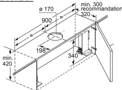
L'installation d'une hotte télescopique de 90 cm dans un meuble haut d'une largeur de 90 cm requiert un kit de montage. Les deux équerres d'installation sont vissées à droite et à gauche dans le meuble. Montage selon gabarit.
