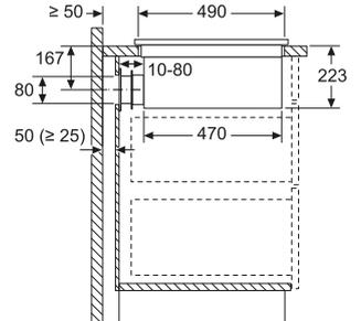
En cas d'installation directement contre des murs extérieurs qui ne sont pas isolés ( $\mu \geq 0,5 \text{ W/m}^2\text{C}$ ), nous recommandons d'utiliser des configurations de recyclage partiellement ou totalement gainées (ci-dessous).
