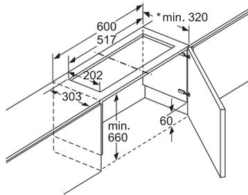
Installation de l'appareil avec module cleanAir Plus
