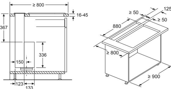
L'utilisation avec une table de cuisson à gaz n'est pas possible. Afin de s'assurer que l'appareil ne perde pas de puissance, n'installez pas d'unités murales au-dessus de l'appareil et conservez les espaces suivants :
