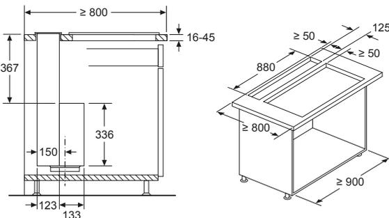
L'utilisation avec une table de cuisson à gaz n'est pas possible. Afin de s'assurer que l'appareil ne perde pas de puissance, n'installez pas d'unités murales au-dessus de l'appareil et conservez les espaces suivants :
