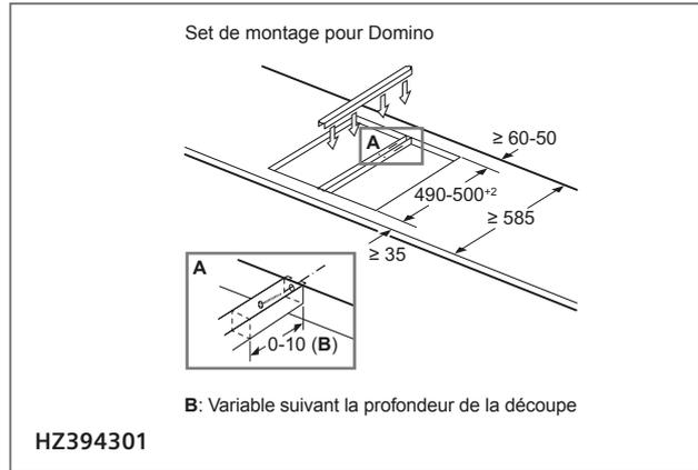
En cas d'encastrement de deux ou plusieurs tables de cuisson avec design à facettes les uns à côté des autres, prévoir un ou plusieurs sets de montage HZ394301 (2 éléments: 1 set; 3 éléments: 2 sets...)
